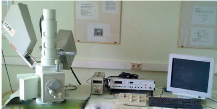
Figure III.14 : Microscope électronique à balayage de marque Jeol JSM-6360LV utilisé au niveau du laboratoire (CDTA)
