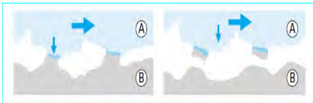
Figure I. 11: Phénomènes élémentaires de l'usure adhésive [15]
