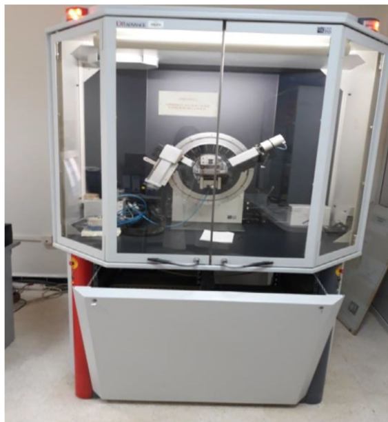
Figure III.12 : Photographie du diffractomètre de rayon X utilisé au niveau du laboratoire (CDTA)
