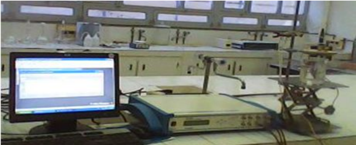
Figure III.23 : Montage utilisé pour la réalisation des essais électrochimiques
