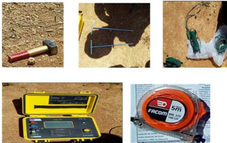
Figure.14 Equipements pour la mesure de la résistivité du sol
