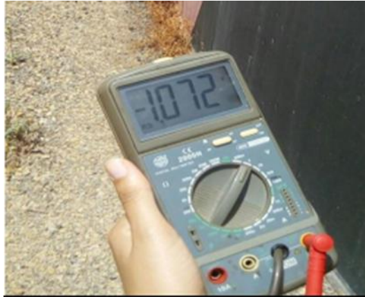
Figure.19 Millivoltmètre haut impédance étalonné
