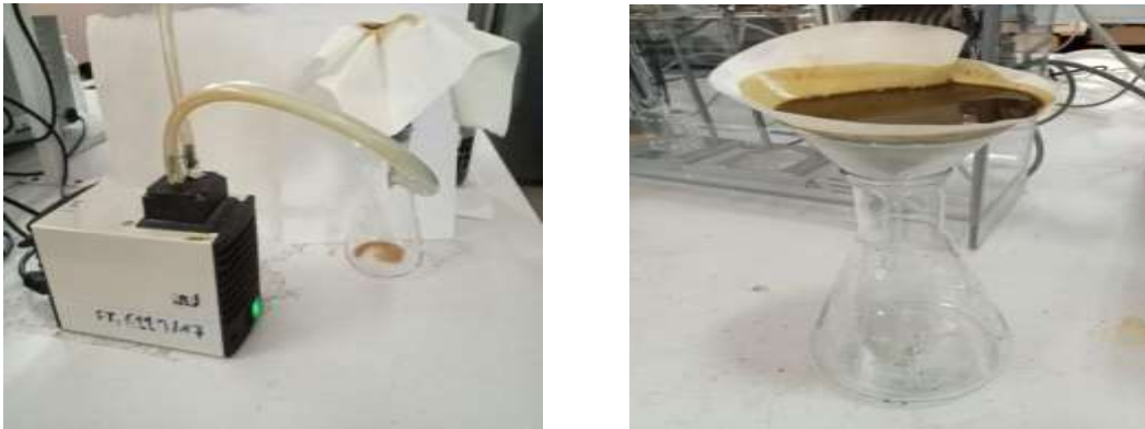
Figure III.28 : filtration sous vide et filtration normale
