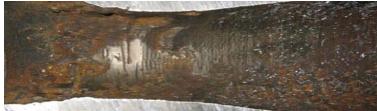
Figure.I.7: Corrosion sous contrainte en présence d'une pression partielle de sulfure d'hydrogène ( H_2S ) élevée
