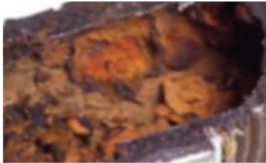
Figure.I.11 : Corrosion galvanique en présence d'un électrolyte
