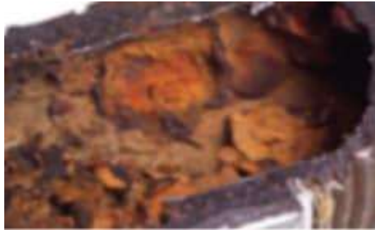
Figure.I.11 : Corrosion galvanique en présence d'un électrolyte
