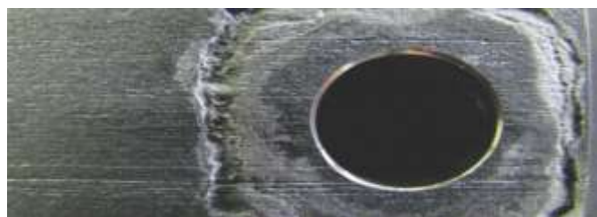
Figure.I.5 : Corrosion caverneuse localisée dans les fluides contenant des ions chlorures
