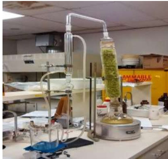
Figure II.19 : montage de l'hydrodistillation
