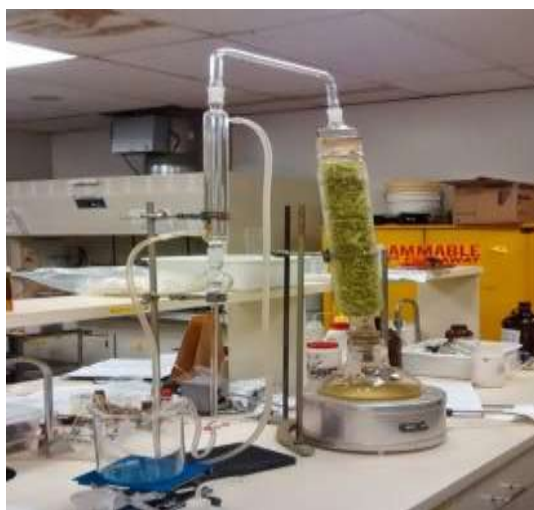
Figure II.19 : montage de l'hydrodistillation
