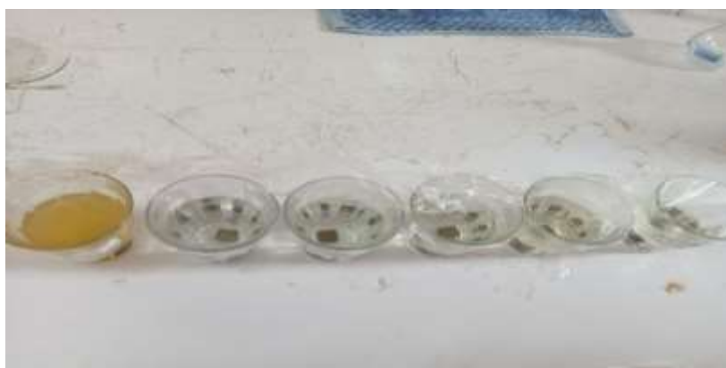
Figure III.33 : 6 solutions à différents concentrations d'inhibiteur chimique
