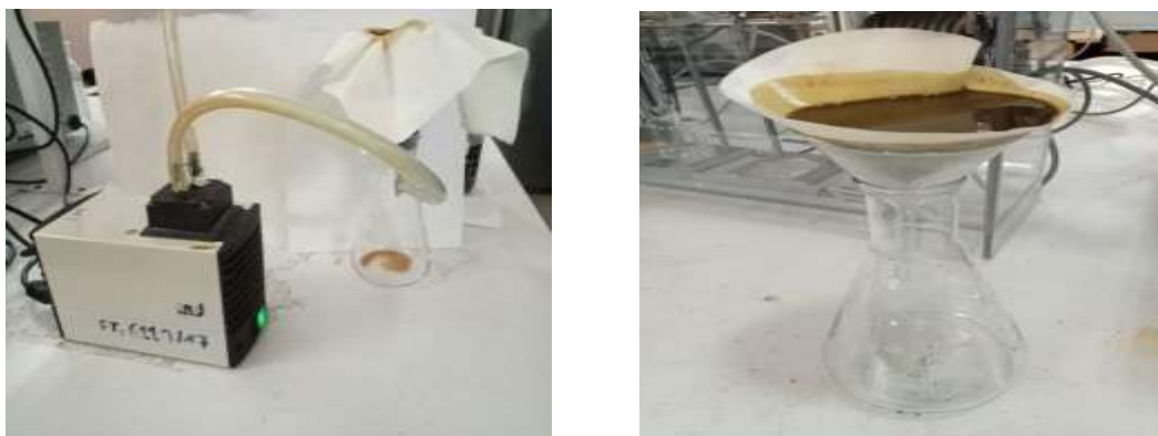
Figure III.28 : filtration sous vide et filtration normale
