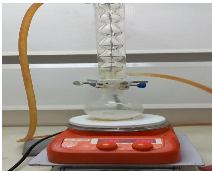
Figure III.4 : Photo de montage de la synthèse des films en PA11.
