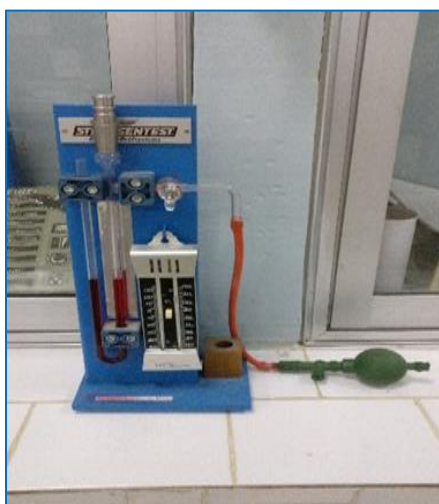
Figure II-3: Mesure de la surface spécifique de Blaine
