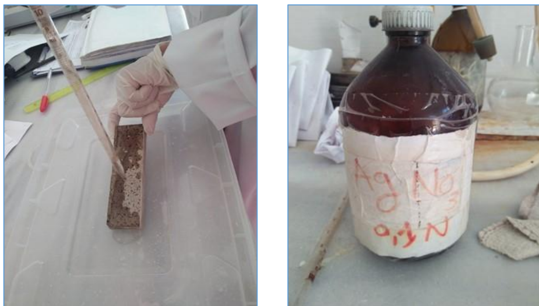
Figure III-21: Eprouvette coupée en deux et versement du \text{AgNO}_3
