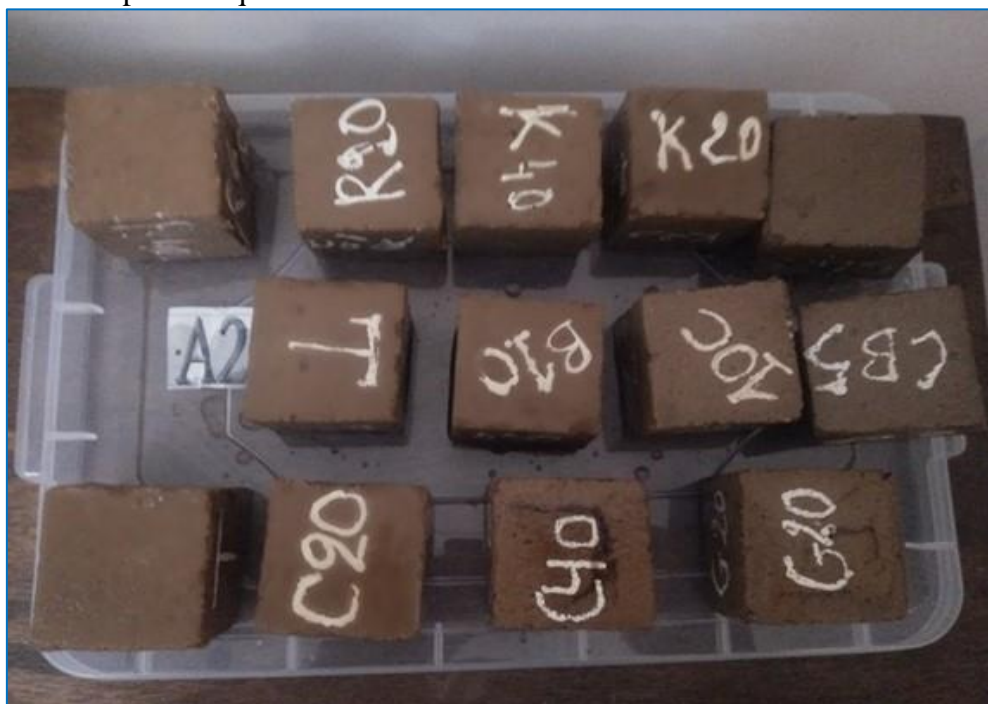
Figure V-13: Éprouvettes traitées par l'acide CH_3COOH
