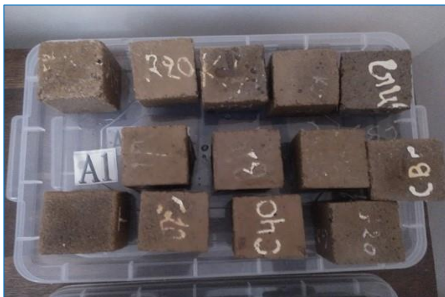
Figure V-15: Éprouvettes traitées par l'acide HCl
