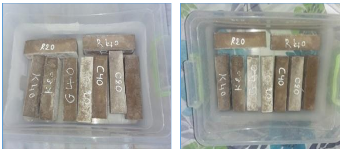
Figure III-16: Conservation des éprouvettes destinées aux retraits et gonflements
