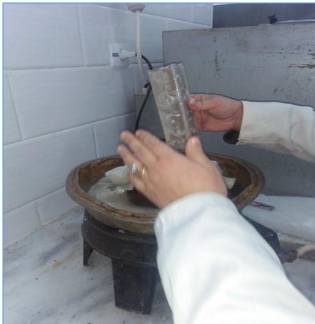
Figure III-19: Paraffinage des éprouvettes
