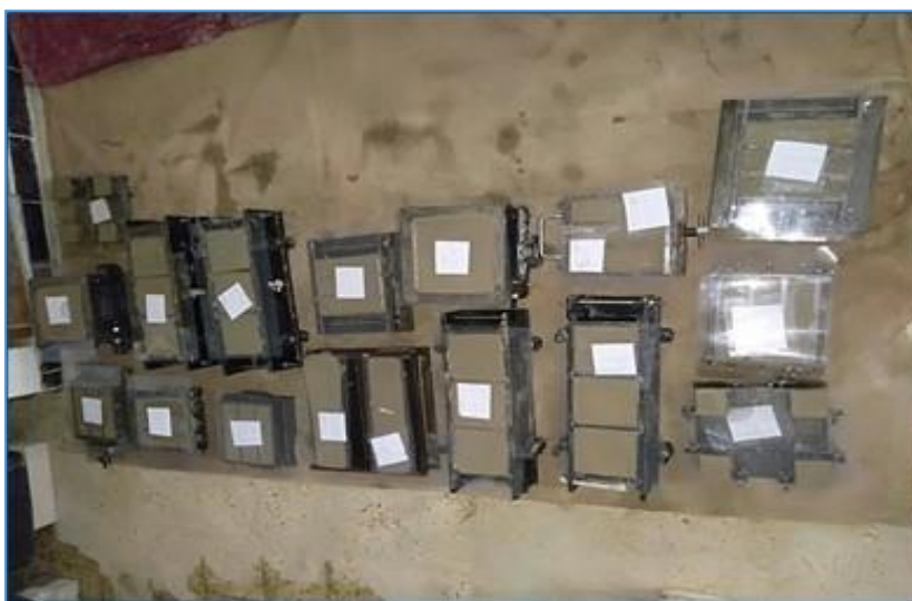
Figure III-2: Éprouvettes avant le démoulage
