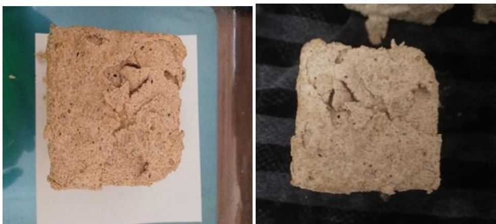
Figure V-16: Perte des masses des bétons en fonction de la période d'immersion dans 4% H 2 SO 4
