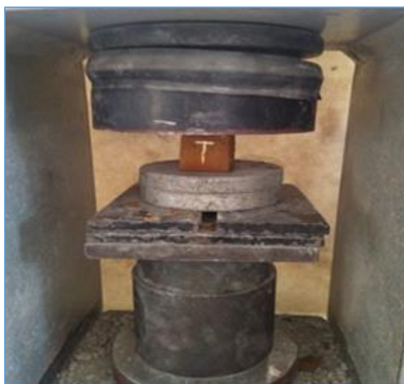
Figure III-18: Essai de compression sur éprouvette soumise à l'attaque chimique
