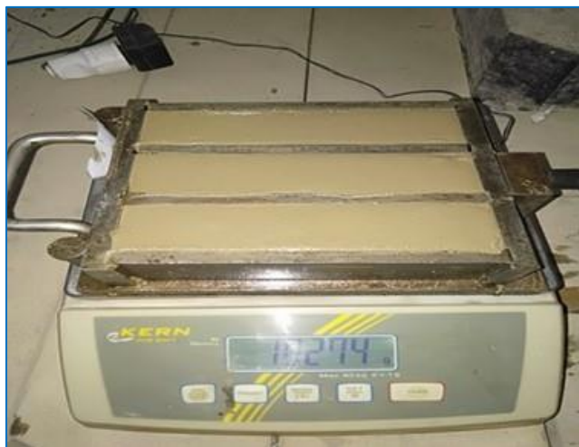
Figure III-4: Mesure de la masse volumique du béton frais
