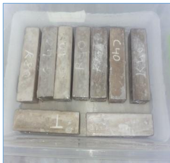
Figure III-20: Conservation des éprouvettes dans une solution de 5% NaCl
