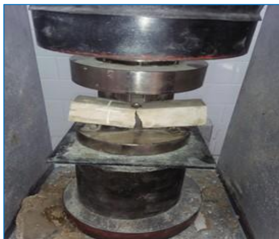
Figure III-7: Essai de traction par flexion trois points
