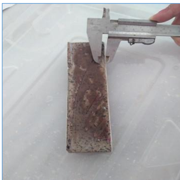
Figure III-22: Mesure de la profondeur de pénétration des chlorures
