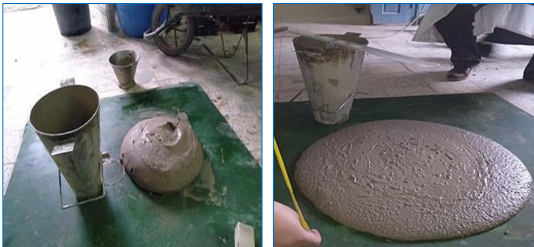
Figure III-5: Affaissement au cône d'Abrams
