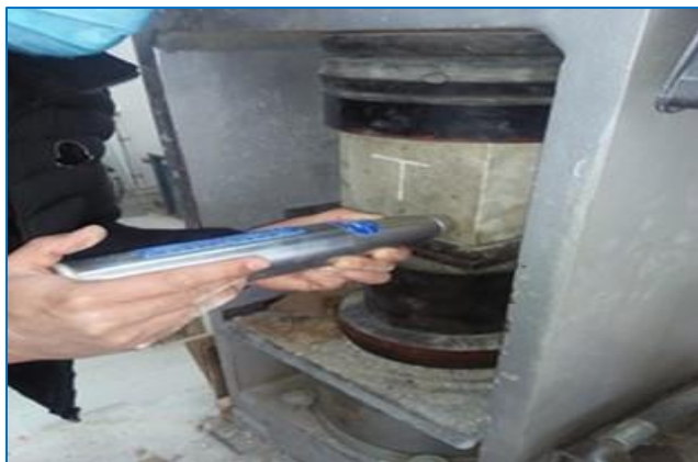
Figure III-10: Essai au scléromètre
