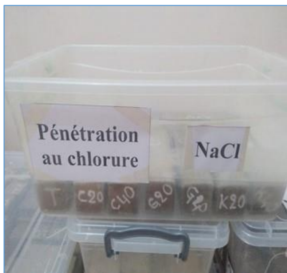
Figure III-20: Conservation des éprouvettes dans une solution de 5% NaCl
