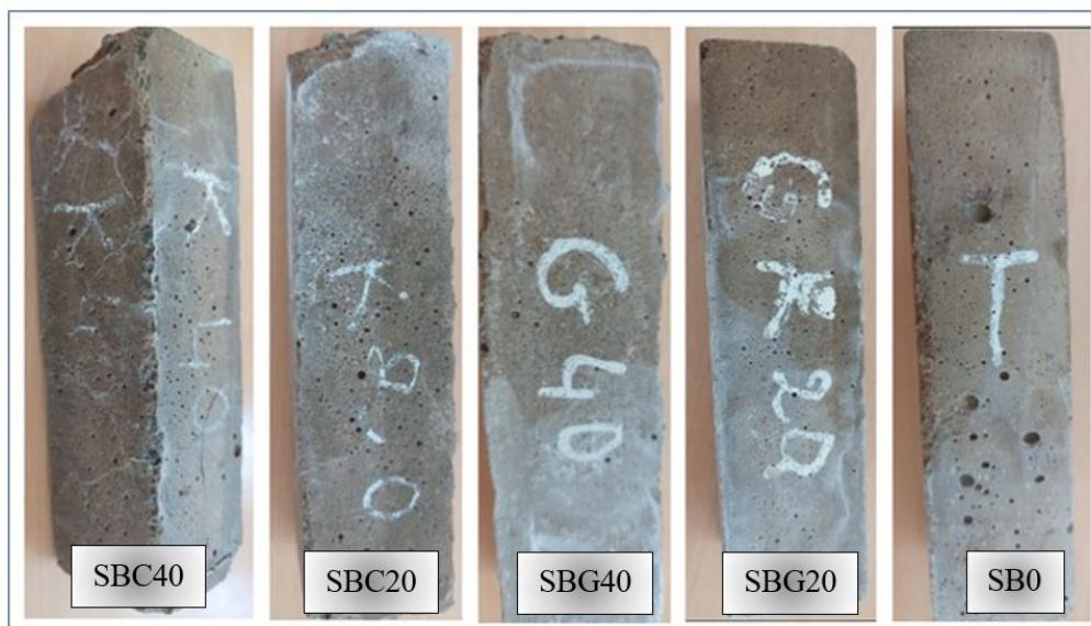
Figure V-26: Observation visuelle des éprouvettes après les cycles gel/dégel
