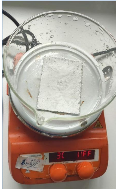
Figure III.27 : Nettoyage d'un échantillon teinté et entartré.
