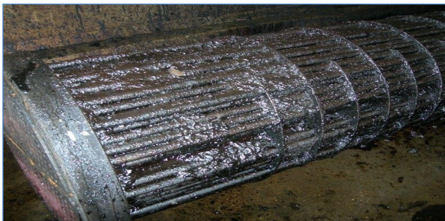
Figures II.8 : Dépôt solide par solidification sur échangeur thermique.[53]
