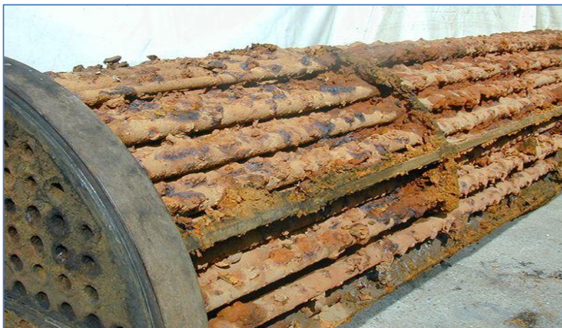
Figures II.6 : Entartrage dans un échangeur thermique.[50]
