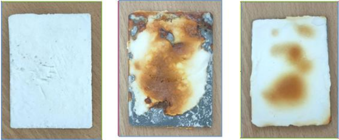
Figure III.21 : le dépôt du tartre après huit jours de séchage.
