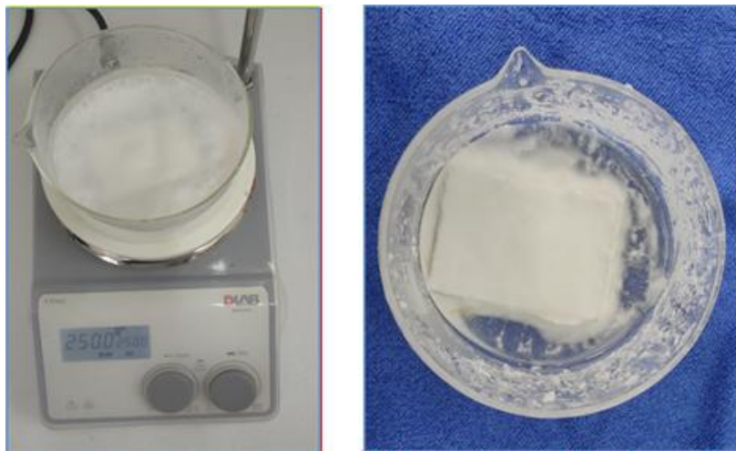
Figure III.20 : formation du tartre après 30 min de chauffage.
