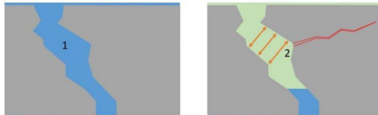
Figure 1.21. Fissuration du béton sous l'action de gel
