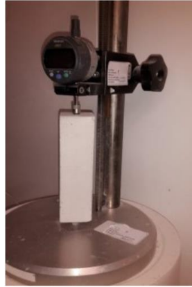
Figure 1.16. Mesure de retrait du béton par rétractomètre.
