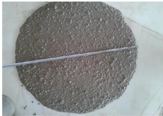
Figure 3.4. Essai d'étalement au cône d'Abrams
