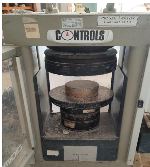
Fig.IV.7 Essai de compression.
