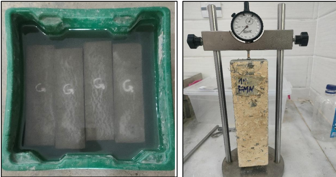
Fig.IV.12 Essai de gonflement.
