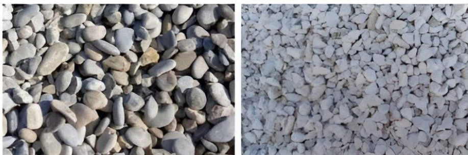
Figure 1.9 : Photos des gravillons roulés (à gauche) et concassés (à droite)
