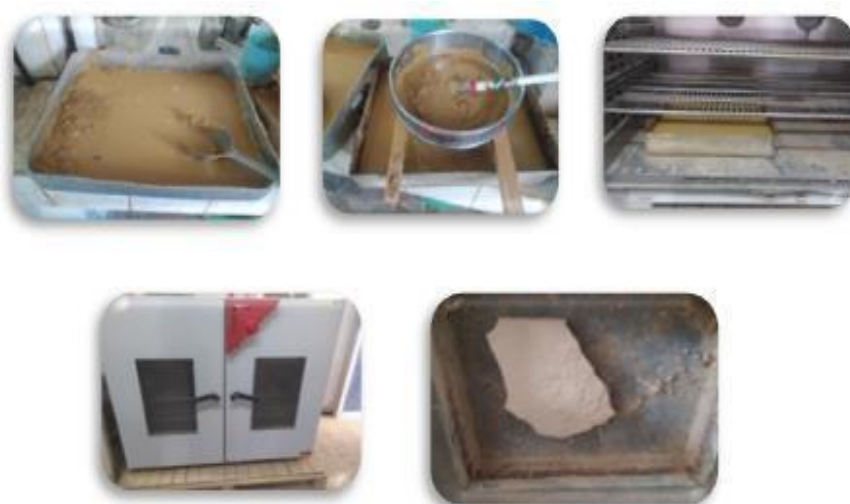
Figure 2.8 : Préparation de l'échantillon du sol pour l'essai des limites d'Atterberg.
