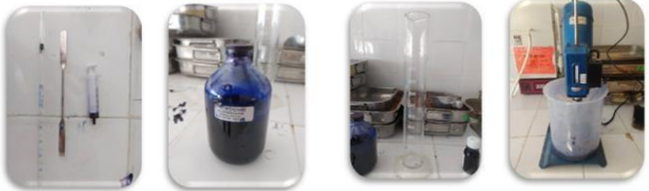
Figure 2.3 : Appareillage de l'essai du bleu de méthylène.
