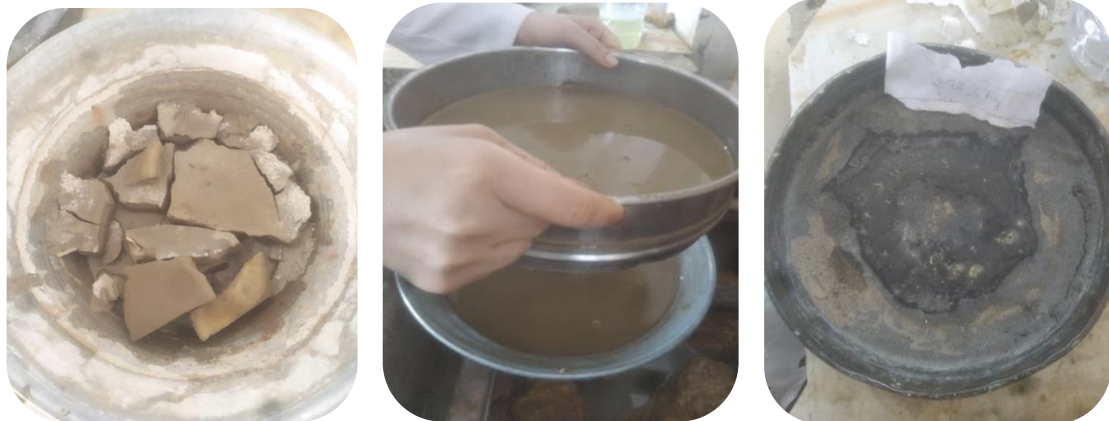
Figure 2.5 : Préparation de l'échantillon du sol.
