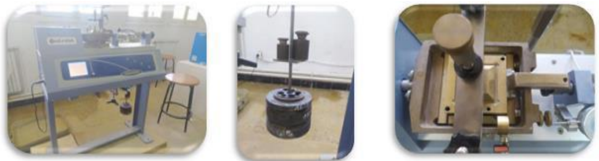
Figure 2.11 : Matériel essai de cisaillement a la boite.
