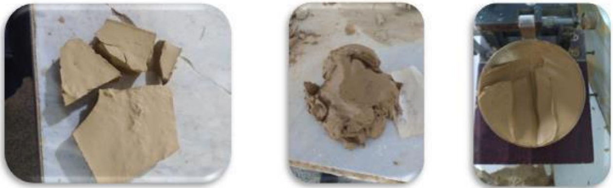
Figure 2.9 : Détermination de la limite de liquidité (Wl).
