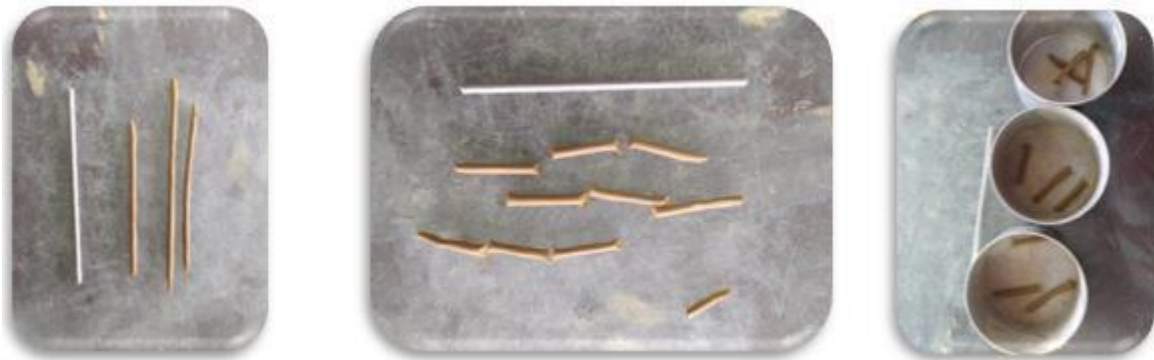
Figure 2.10 : Détermination de la limite de plasticité ( W_p ).
