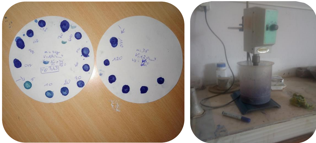
Figure 2.4 : L'essai de valeur au bleu de méthylène
