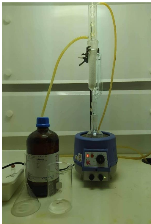
Figure III.20 : Montage d'extraction de l'extrait gras par Soxhlet
