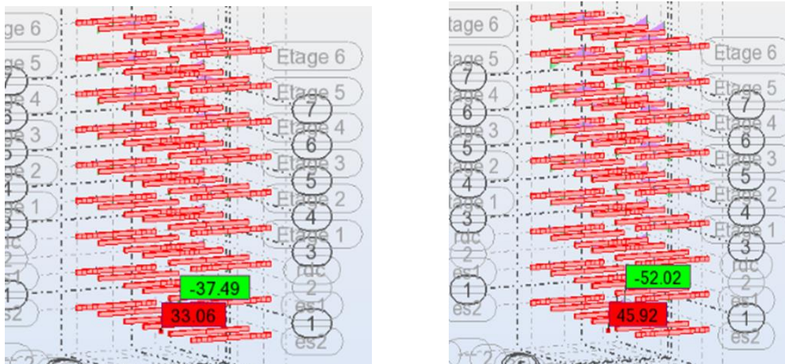
Figure 70 - Diagramme des moments fléchissants à ELU et ELS
