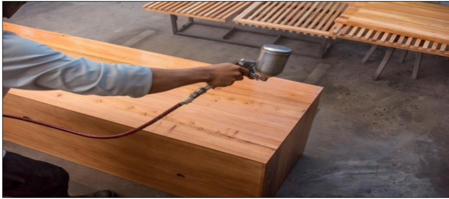
Figure I.12 : Application du vernis par pulvérisation [48].
