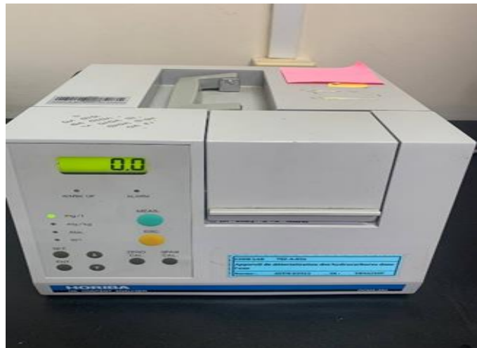
Figure N°18 : Appareil de détermination des hydrocarbures dans l'eau ASTMD3921 (HORIBA).
