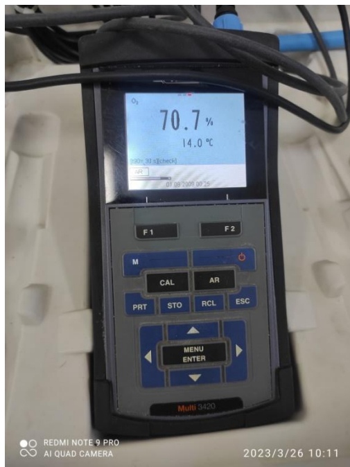
Figure 04. Un oxymètre mètre.
