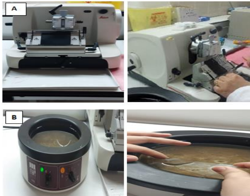
Figure 24 : Technique de préparation des coupes sur les lames A- le microtome B- le bain marie (photos originales, 2022)
