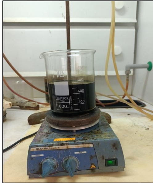
Figure III.13: Montage expérimental de la régénération à l'acide
