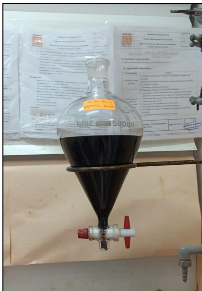
Figure III.14: Huile traitée à l'acide en décantation
