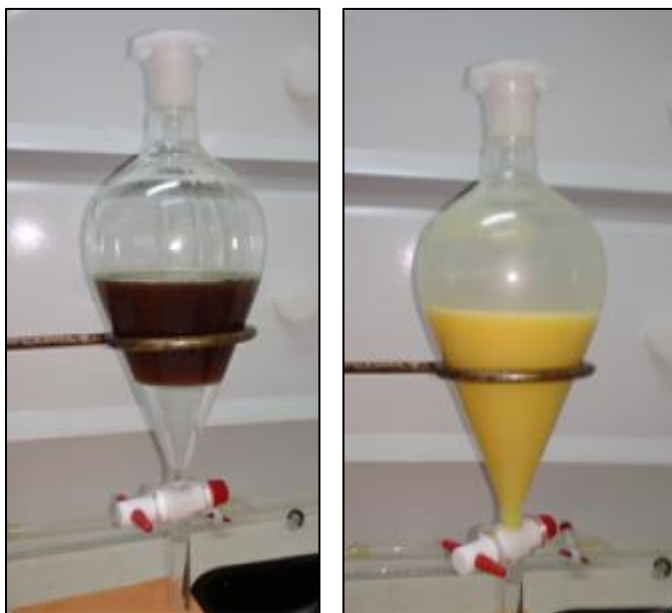
Figure III.16: Neutralisation de l'acide par NaOH
