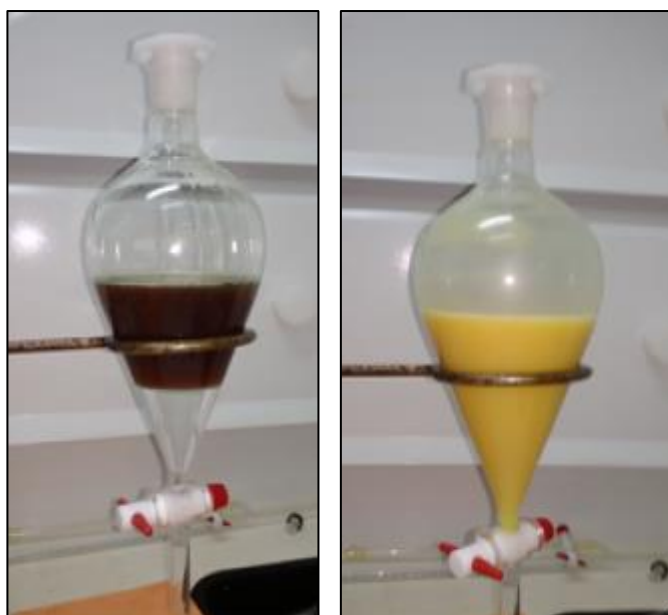
Figure IV.4: Neutralisation par NaOH
