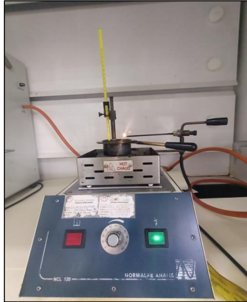
Figure IV.15: Mesure de point d'éclair de type Cleveland Cup
