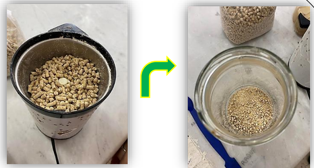
Figure III. 14: Broyage du tourteau avec un moulin.
