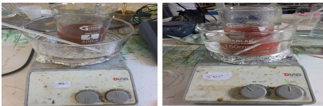
Figure III.9 : Dispositif expérimental de l'adsorption du Rouge Congo par les CuO NPs à différentes températures.
