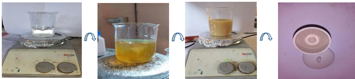
Figure III.4 : Les étapes de formation des nanoparticules (ZnO NPs).
