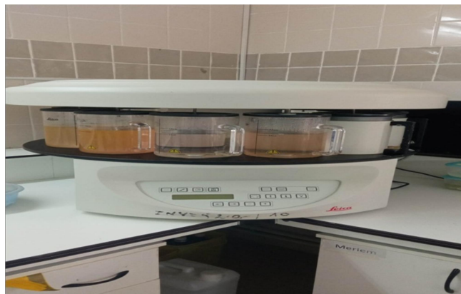
Figure 21 : Automate pour la circulation (photo originale)
