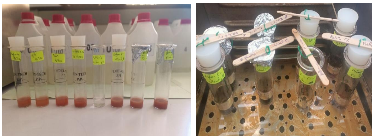
Fig IV.17 : Effet de température sur la corrosion.
