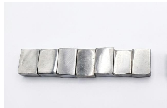
Fig IV.9 : L'acier avant et après le polissage.
