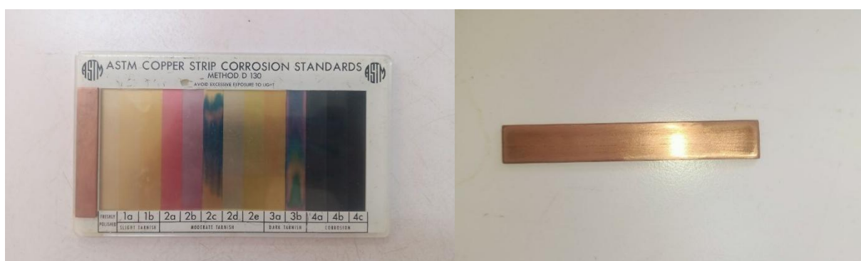
Fig IV.28 : Comparaison de la lame de cuivre après essai avec l'échelle de référence ASTM D130.
