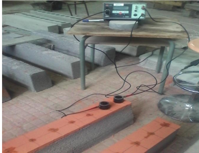
Figure IV.1 : Essais ultrasoniques du mortier prêt à l'emploi sur support en béton
