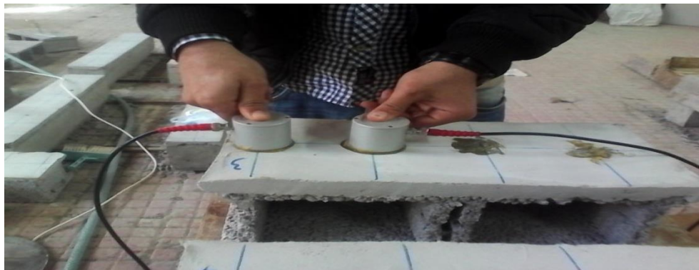
Figure II.13 : Photo des essais ultrasoniques sur le revêtement par le mortier préparé.
