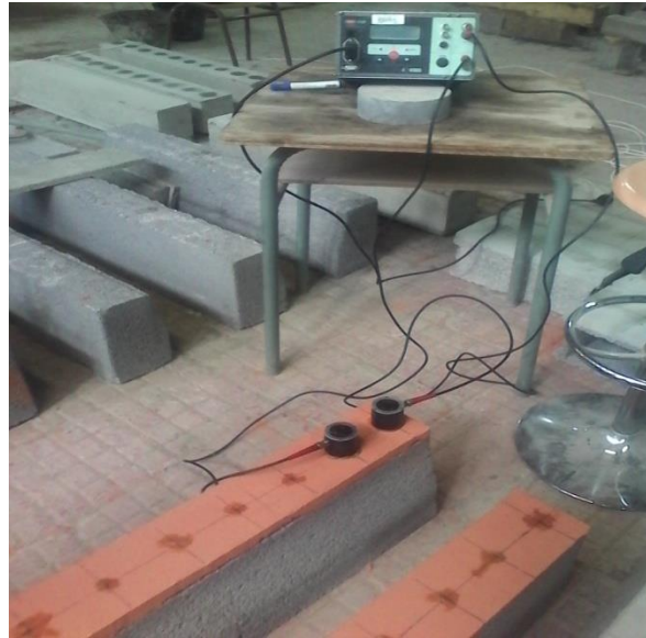
Figure II.14 : Photos des essais ultrasoniques sur revêtement par le mortier industriel prêt à l'emploi.
