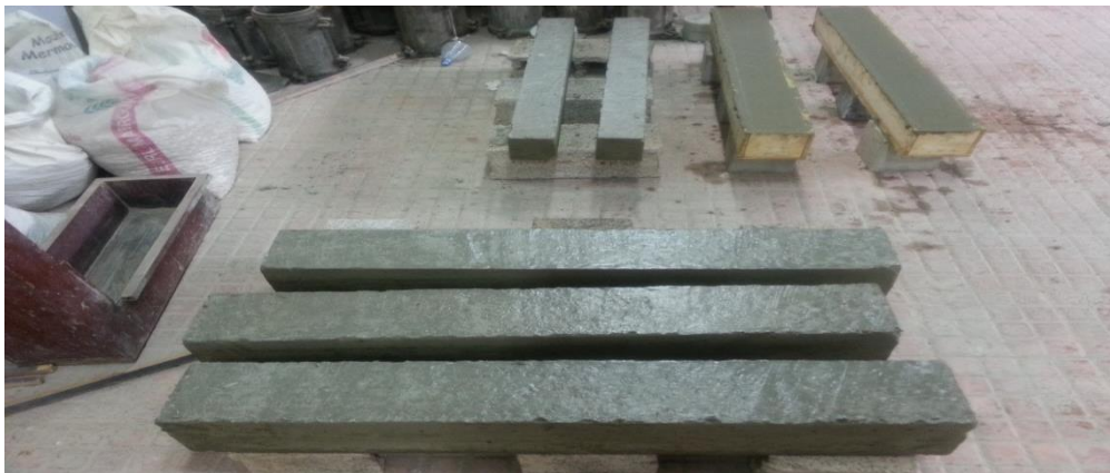
Figure II.4 : Les poutrelles en béton.
