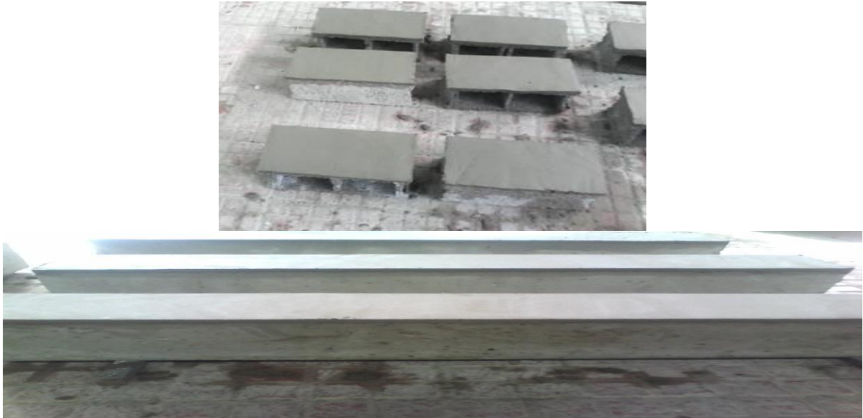
Figure II.5 : Photos des supports revêtus par une couche de mortier préparé.
