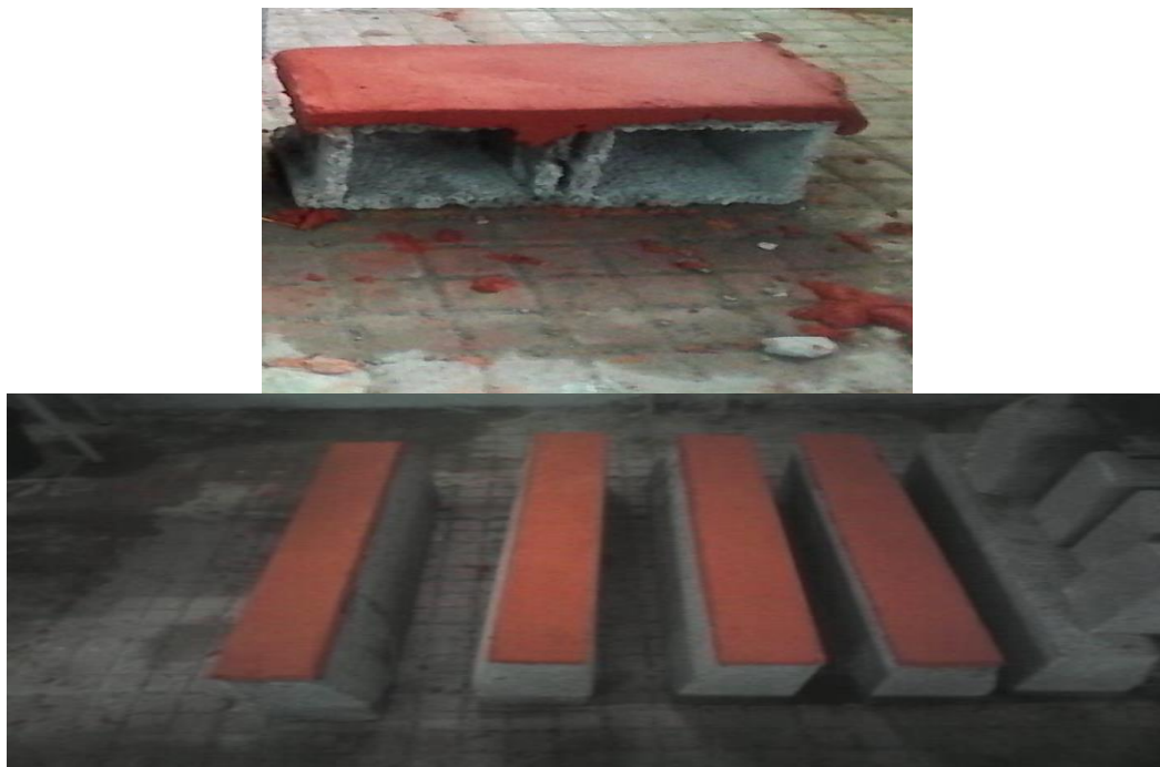
Figure II.6 : Photos des supports revêtus par une couche de mortier industriel prêt à l'emploi.
