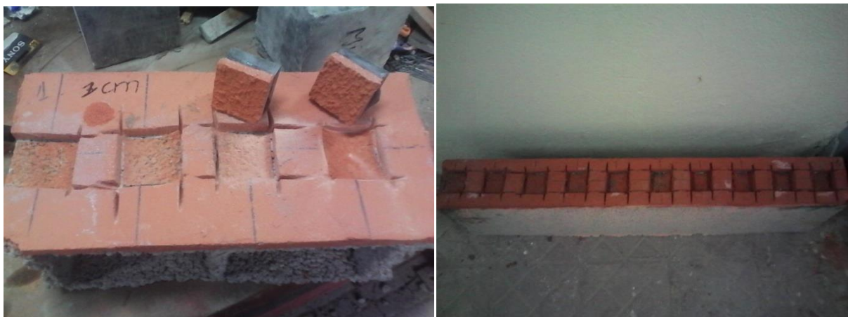
Figure II.21 : Photos des ruptures lors des essais destructifs (arrachement) sur le mortier industriel prêt à l'emploi
