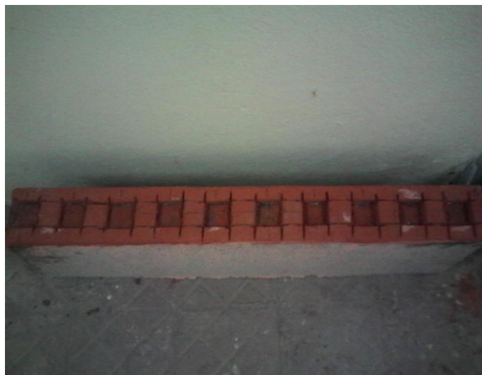
Figure IV.3 : Essais d'arrachement du mortier industriel sur support en béton
