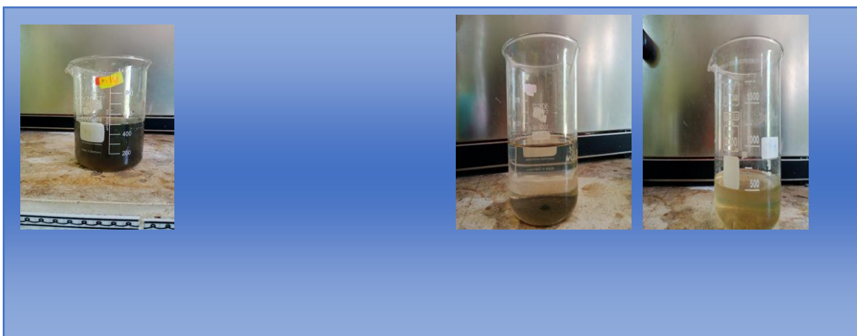
Figure V.14 Dépollution des eaux industrielles par NPs (Ag+Zn) et plante.
