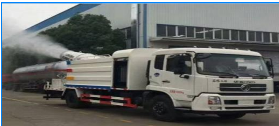
Figure 9. Camion pulvérisateur d'eau et dorloter pour réduire la poussière (Source : Société de cimentrie Hadjar Soud, 2022).
