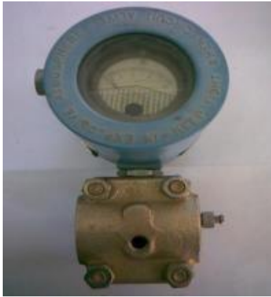
Figure II.2-4 Transmetteur de débit
