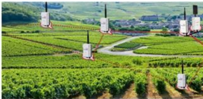
Figure 1.10: utilisation des capteurs météo dans l'agriculture avec RCSF
