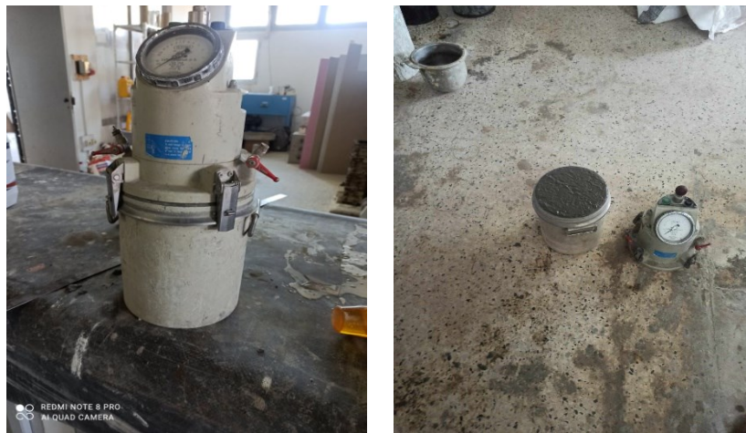
Figure 2.8: mesure de la teneur en air occlus à l'aide de l'aéromètre.
