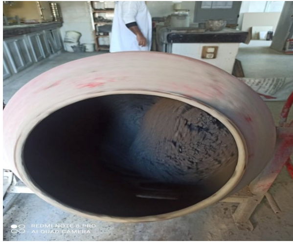
Figure 2. 4 : Malaxeur de béton à axe horizontal utilisé.
