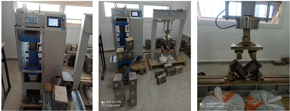
Figure 2.10: Dispositif de l'essai de compression et de traction par flexion.
