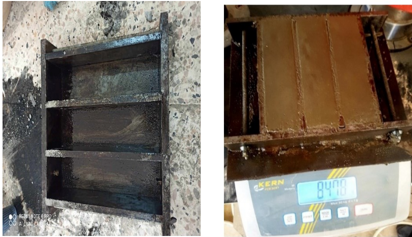
Figure 2.9: mesure de la densité.
