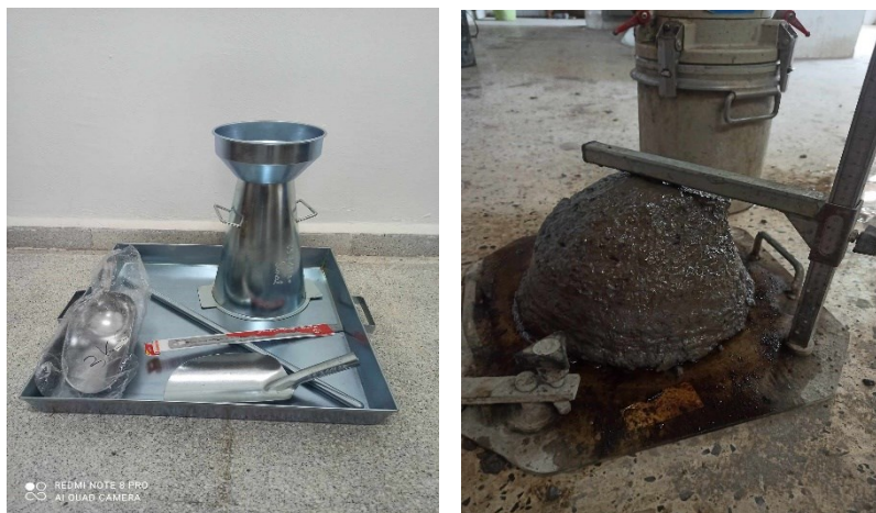
Figure 2.7: Essai d'affaissement au cône d'Abrams.
