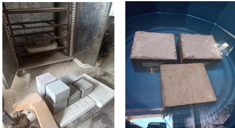
Figure 2.12: Essai d'absorption par immersion.
