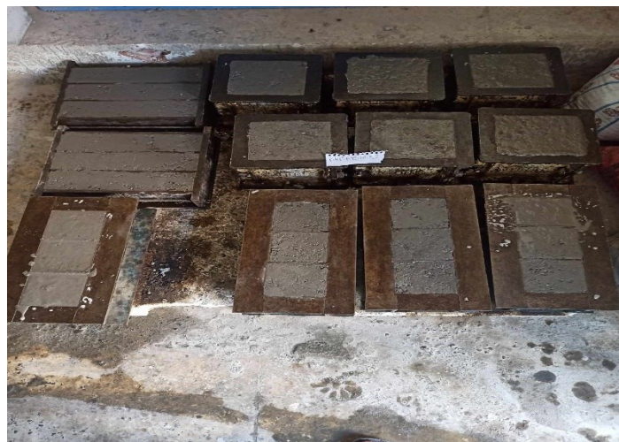
Figure 2. 5 : Remplissage des éprouvettes.
