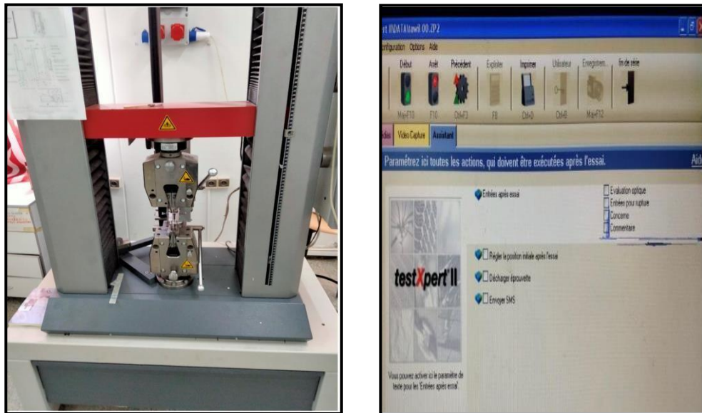
Figure III. 17. Machine de traction « Zwick/Roell Z050 » et logiciel « TestXpert »
