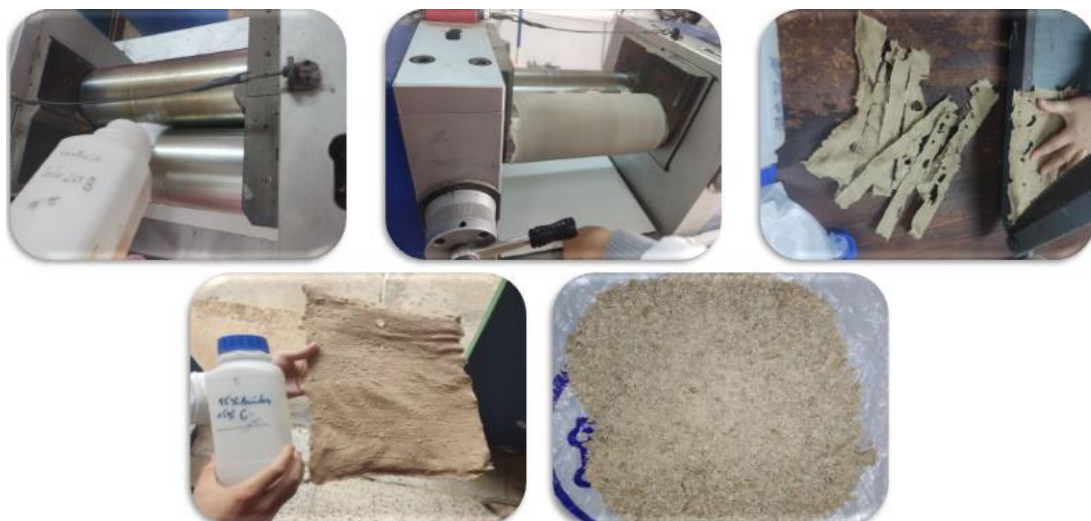
Figure III.4 : Processus de mélange des granulés à l'aide d'un malaxeur chauffé
