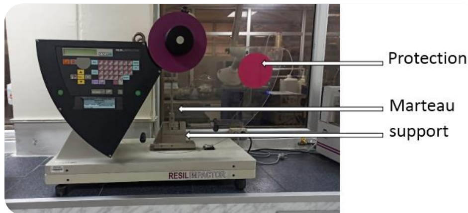
Figure III.9 : Appareillage pour le calcul de la résilience selon l'essai IZOD
