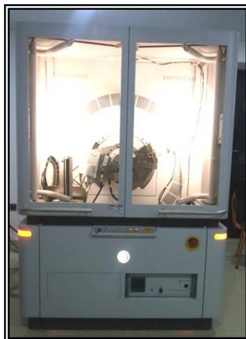
Figure II. 6. Diffractomètre X'Pert PRO (Panalytical) utilisé pour l'analyse des nano-fibres avant et après décoration.
