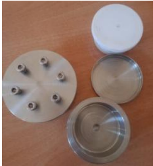
Figure II. 1. Image représentant les différentes pièces d'une bombe hydrothermale (autoclave).
