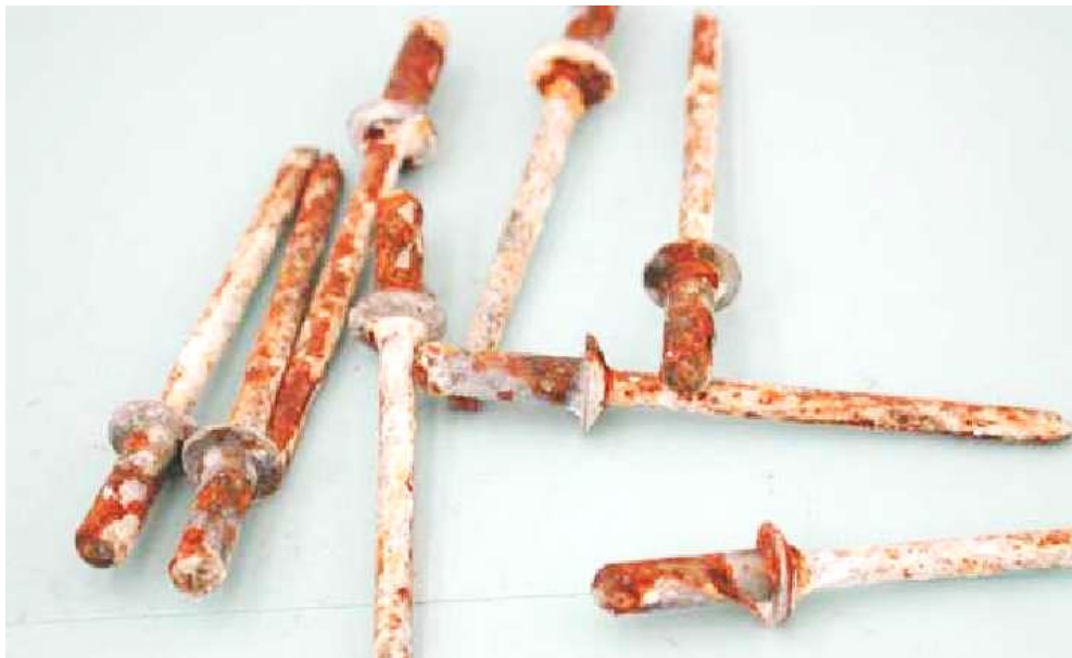
Figure I.4 : Corrosion chimique : effets sur les rivets et les inserts
