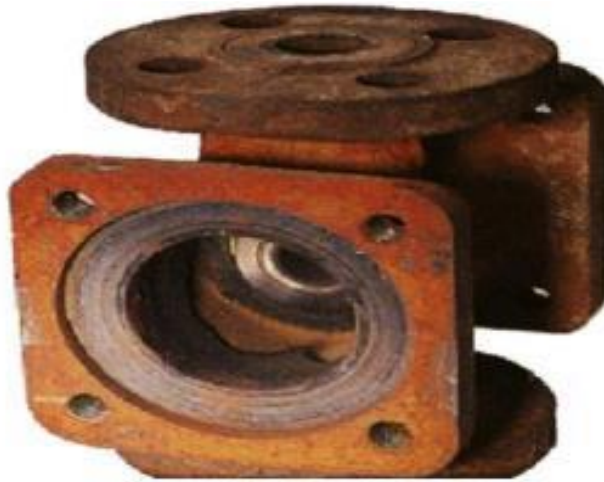
Figure I.2: Corrosion généralisée (rouille) d'une pièce en acier
