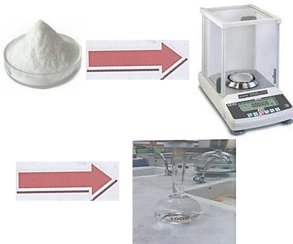
Figure II.12 : Préparation de la solution électrolytiques (NaCl 3.5%)
