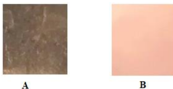
Figure II.11 : Plaque de cuivre avant polissage (A) et après le découpage polissage (B)
