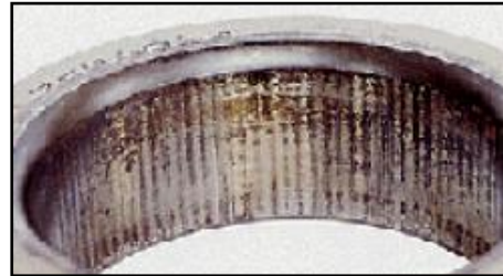
Fig. III. 28 : Corrosion de contact sur la bague intérieure d'un roulement de Contact angulaire.
