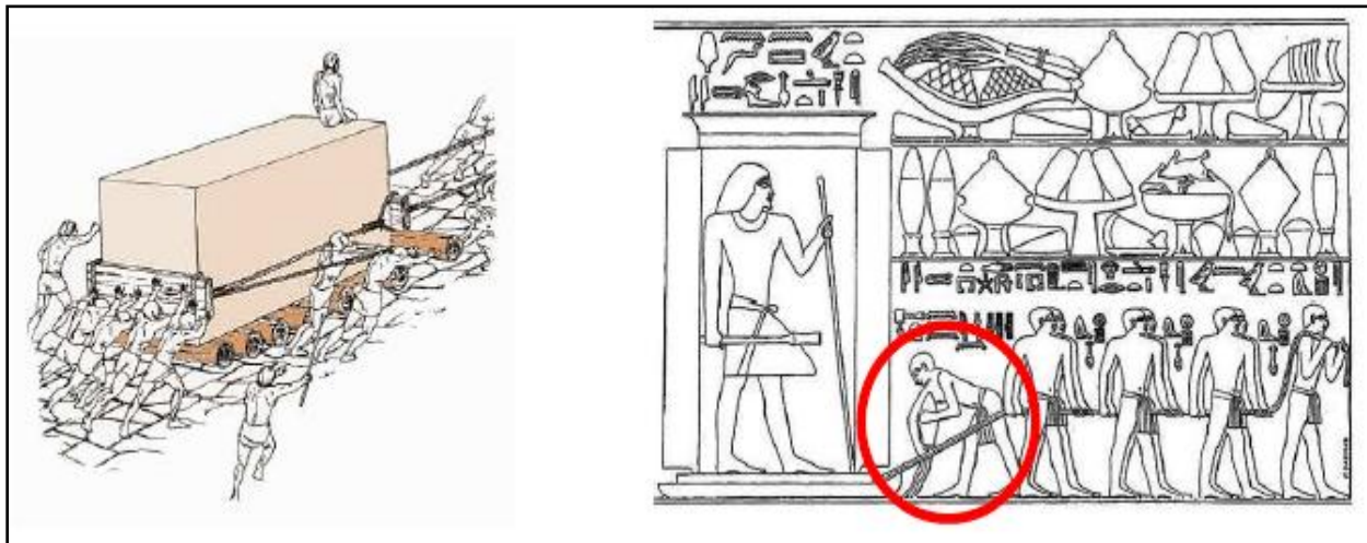
Remplacement du frottement de glissement par le frottement de roulement
