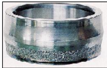
Fig. III. 21 : Ecaillage de fatigue sur la bague intérieure d'un roulement à rouleaux sphérique.
