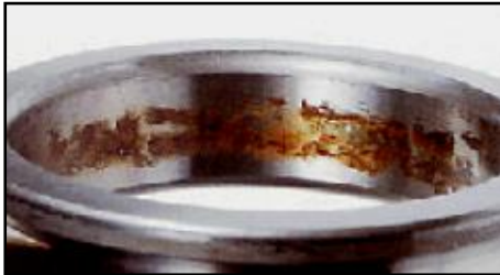
Fig.III. 27: Corrosion de contact sur la bague Intérieur d'un roulement à rouleaux sphérique.
