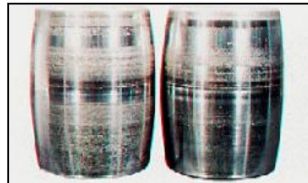
Fig. III. 25 : Grippage sur les rouleaux.
