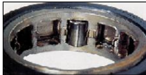
Fig. III. 31 : Déformation de cage d'un roulement à rouleaux cylindrique.
