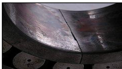
Fig. III. 33 : Usure par coloration de la bague externe
