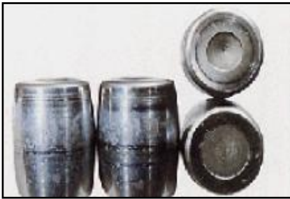
Fig. III. 22 : Écaillage superficiel sur rouleaux.
