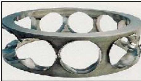
Fig. III. 32: Déformation de cage d'un roulement à billes de contact angulaire.
