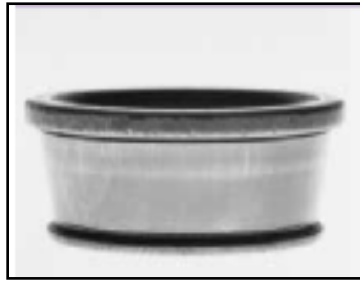
Fig. III. 30: Usure par abrasion d'une bague interne.
