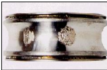
Fig. III. 20 : Ecaillage sur la bague intérieure d'un roulement à billes à gorges profonde.
