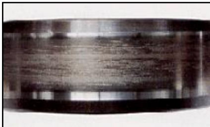
Fig. III. 24 : Grippage sur la bague intérieure d'un roulement à rouleaux cylindrique.
