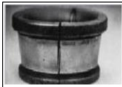
Fig. III. 29: Fissure longitudinal de la bague interne.
