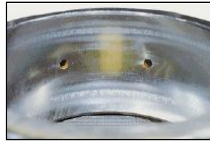
Fig. III. 23 : Ecaillage superficiel sur la bague extérieure d'un roulement à rouleaux sphériques.
