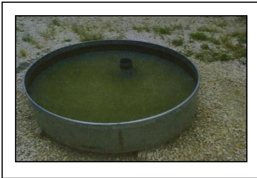
Figure 3.3. Bac d'évaporation (classe A) au niveau du barrage de Zit Emba
