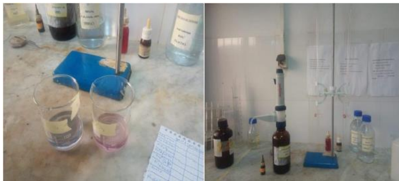
Fig.13: L'équipement utilisé pour déterminer la dureté.
