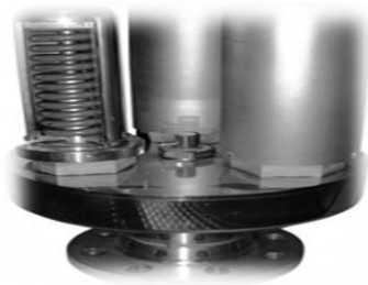
Figure IV.18 : collecteurs et soupapes de sécurité.
