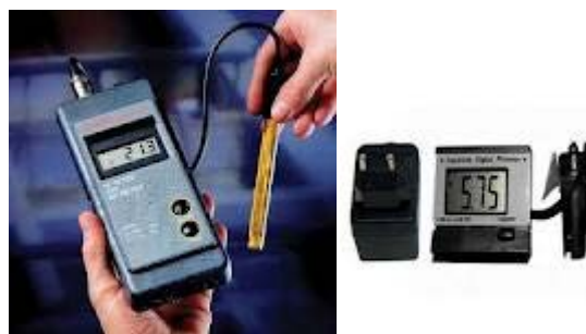
Fig. 11 : pH-mètre avec sonde renouvelable
