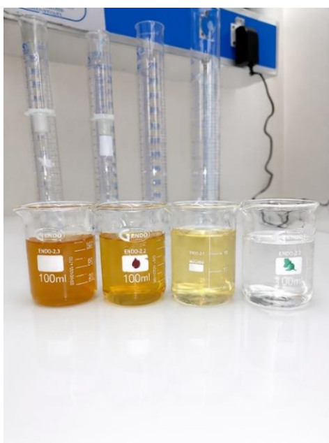
Figure II.4 : Évolution de la coloration de l'eau lors du lavage du biomatériau.
