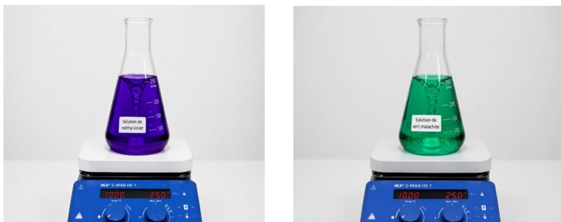
Figure II.19 : Préparation des solutions de cristal violet et vert de malachite sous agitation.
