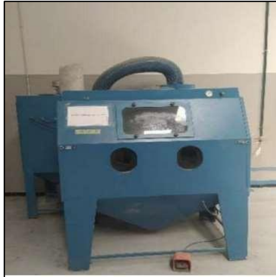
Figure III.2: Sableuse de pression 06 bar
