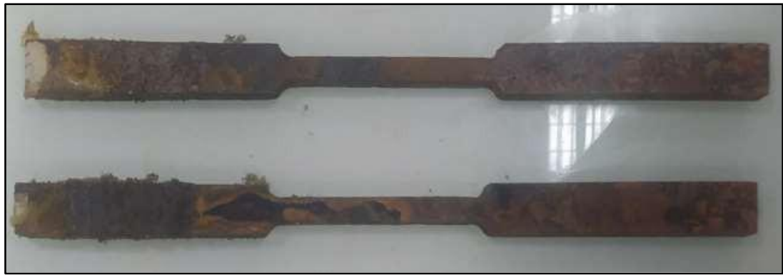
Figure III.5 : Après le traitement avec H 2 SO 4 20%
