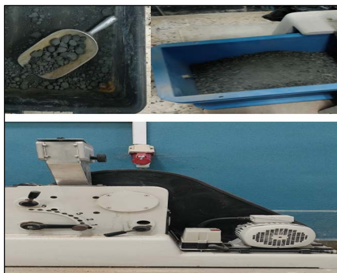
Fig.II.9 Les étapes de broyage du clinker.
