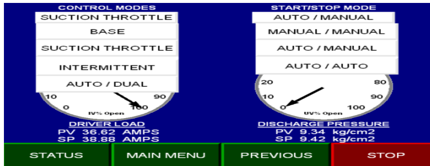
Figure III.14 : Modes de contrôle démarrage/arrêt.
