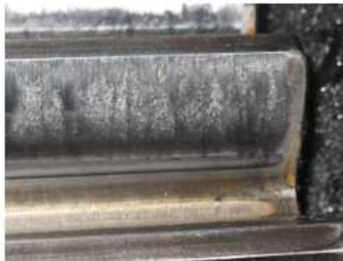
Figure I.15 : Grippage à chaud [18].
