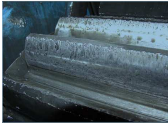
Figure I.14 : Grippage à froid [28].
