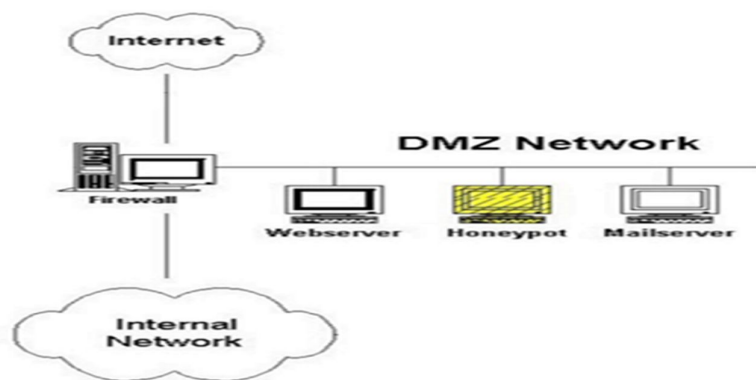
Figure 2.07: Honeypot installé dans une DMZ.
