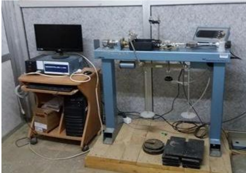
Figure III.23 : Appareille de cisaillement
