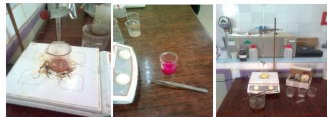
Figure III.14 Essai d'analyse chimique au carbonate
