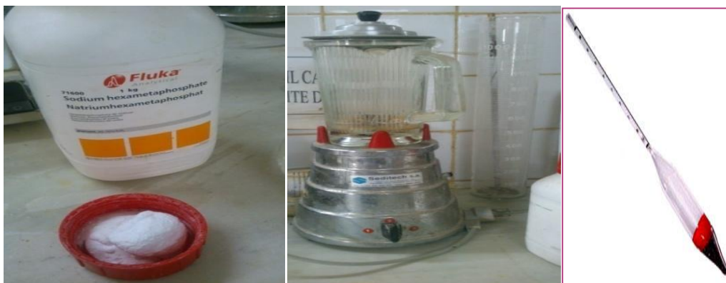
Figure III.4 Appareillage d'analyse granulométrique par sédimentométrie
