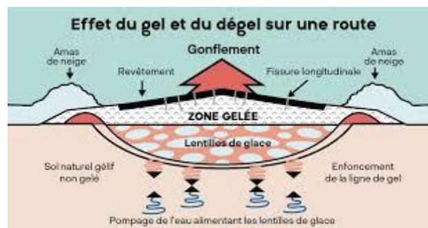
Figure II.5 Effet du gel et du dégel
