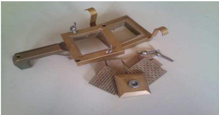
Figure III.24 : Les constituants de la boîte de cisaillement
