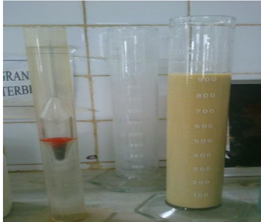
Figure III.5 Granulométrie par sédimentation
