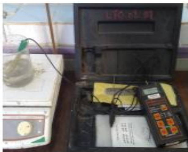
Figure III.15 : Appareil à mesure pH
