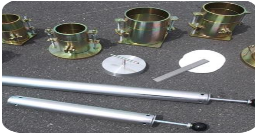
Figure III.17 Matériel et outils de compactage au laboratoire
