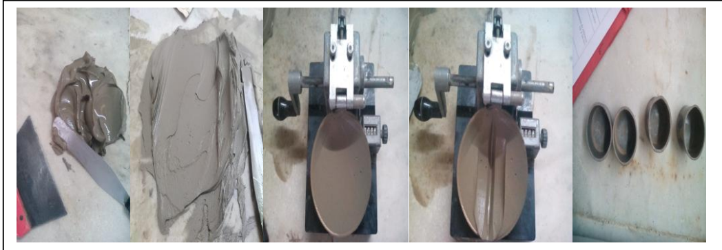
Figure III.9 Essai de la limite de liquidité (l'appareillage de Casagrande)
