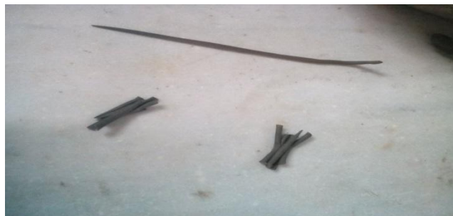
Figure III.10 : Détermination de la limite de plasticité
