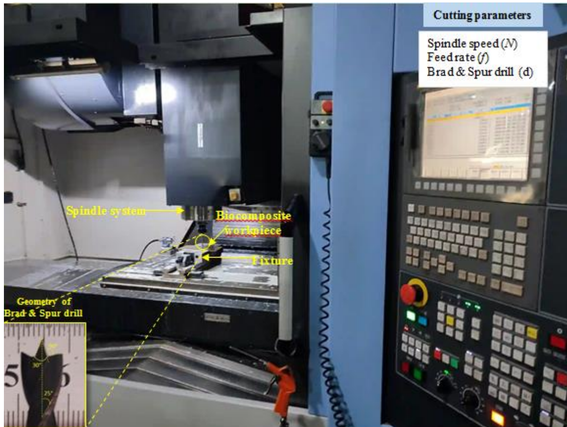
Figure IV. 3 Montage expérimental pour l'essai de perçage de la matrice époxy renforcée par des fibres WF.
