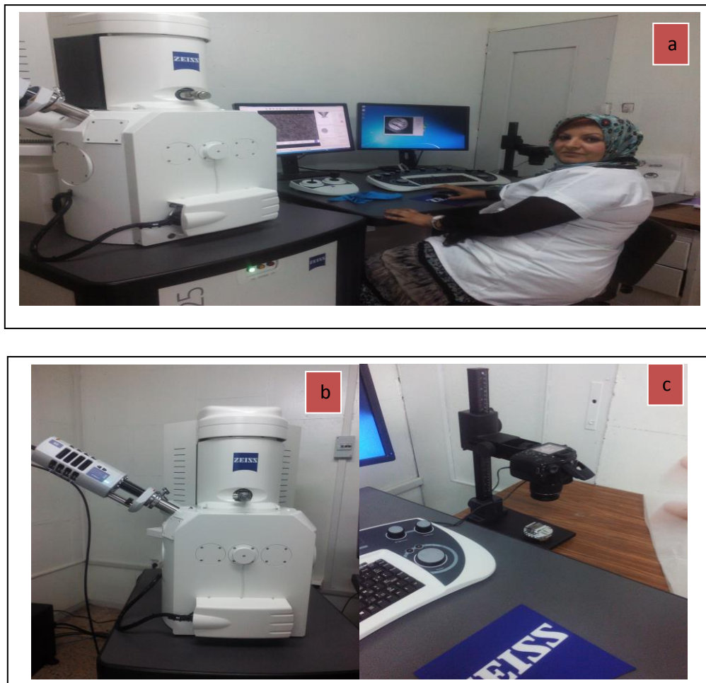
Figure II. 7 Microscope à balayage électronique (MEB) model Zeiss EVOMA 25
