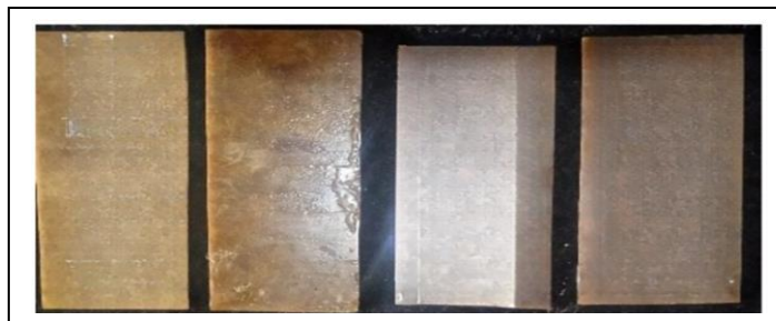
Figure II. 12 Plaques de biocomposite époxy/renfort fibres courtes du PWF
