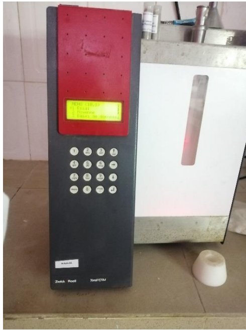
Figure 2.11 : Photographie du perméabilimètre de Blaine utilisé pour la mesure de la surface spécifique.
