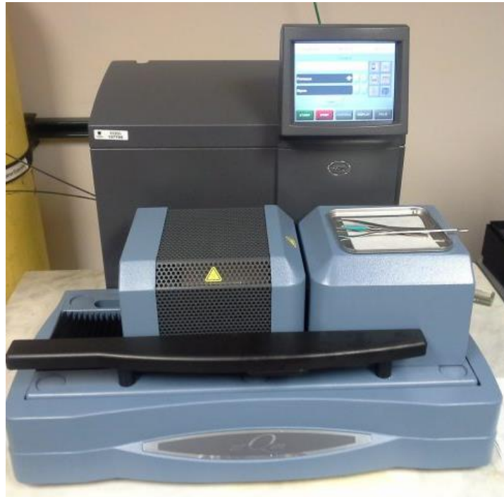
Figure 2.7 : Vue de l'analyseur thermique SDT Q600 utilisé pour l'analyse thermogravimétrique (ATG) [19].
