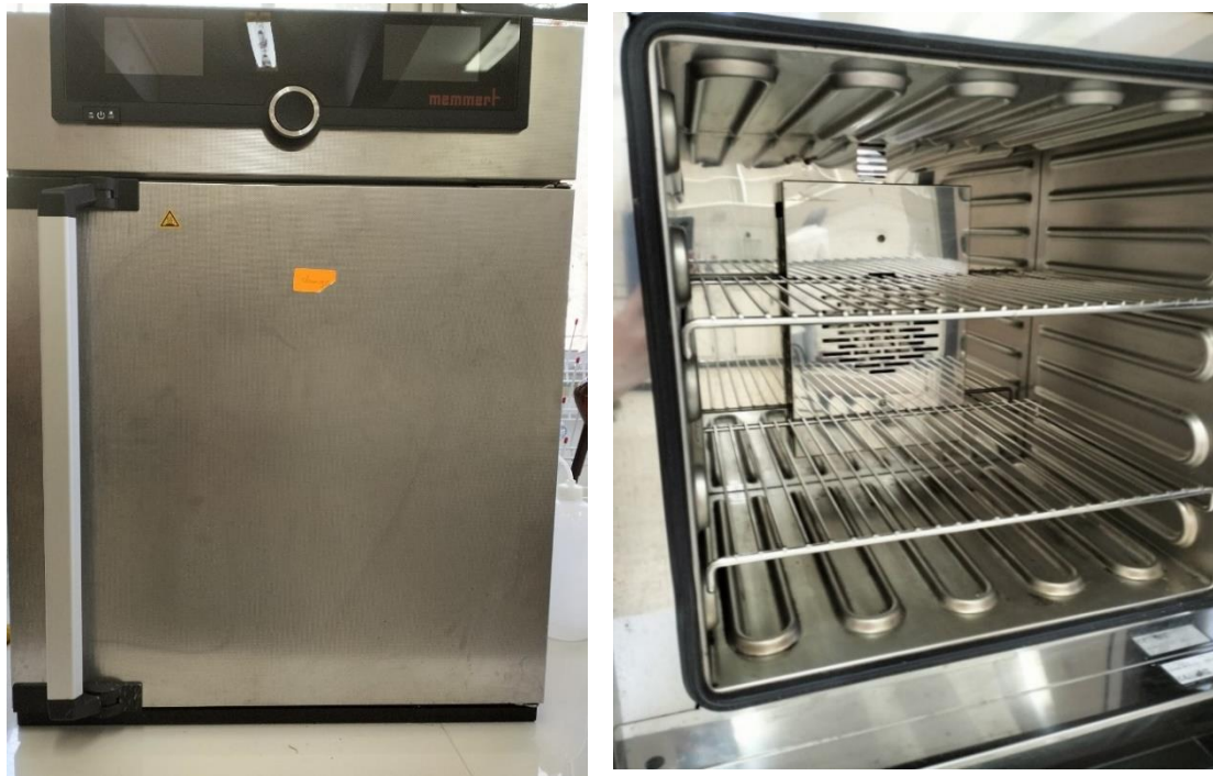
Figure 2.16 : Photographie de l'étuve utilisée pour le vieillissement thermique.
