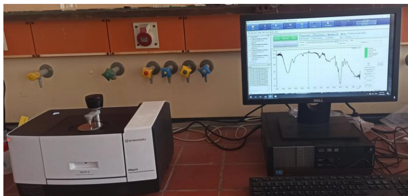
Figure 2.15 : Photographie du spectromètre infrarouge à transformée de Fourier (IRTF) utilisé.
