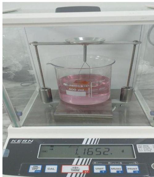
Figure 2.8 : Photographie de l'appareil de mesure de densité.
