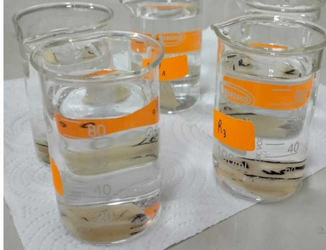
Figure 2.10 : Photographie de l'immersion des échantillons dans l'eau.
