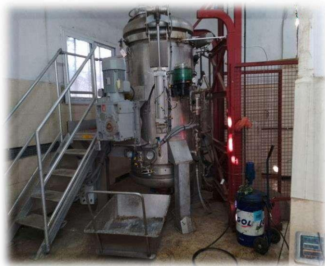
Figure10: Banaliseur de déchets hospitaliers (EPH Skikda,2024)
