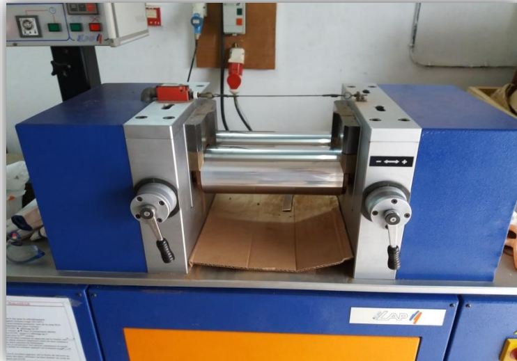
Figure III.3: Appareil de malaxage (Malaxeur à deux cylindres).
