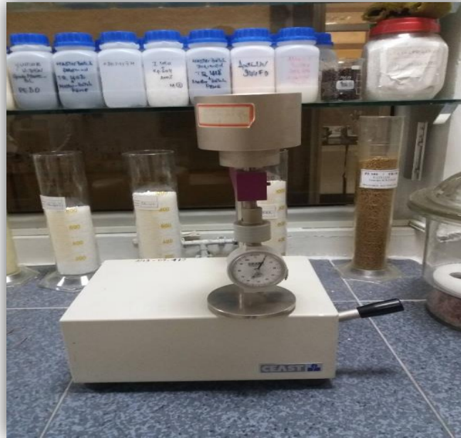
.Figure III.7: Appareillage de mesure de la dureté Shore D.
