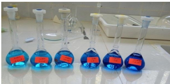
Figure III.4 : préparation de la solution fille de bleu de méthylène de la courbe d'étalonnage
