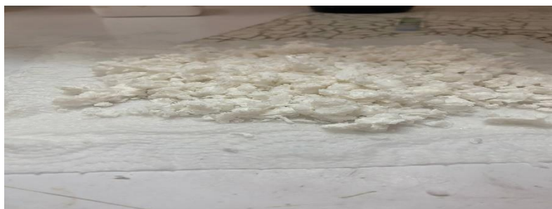
Figure III.6 : PMMA greffé -COOH après hydrolyse et séchage.
