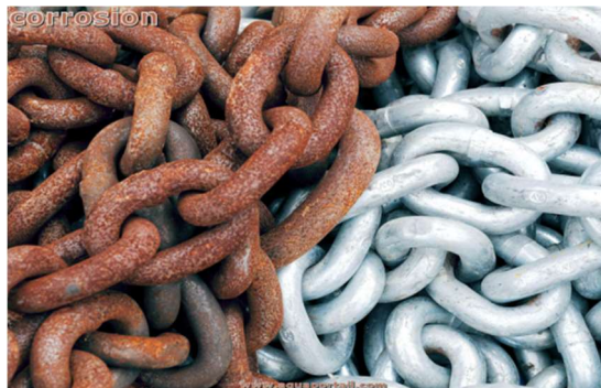
Figure I.1 corrosion d'une chaîne en acier
