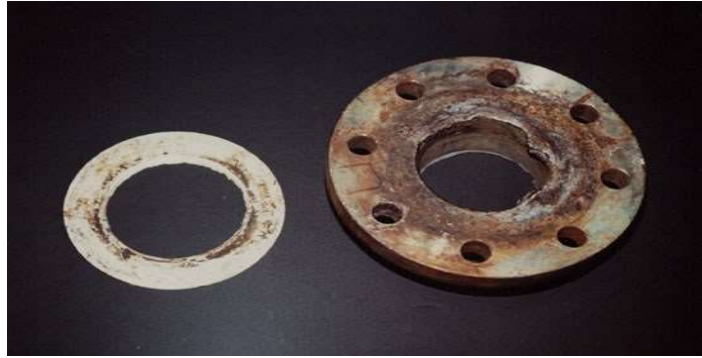
Figure I.9 Corrosion cavernuse d'un acier allié sous un joint
