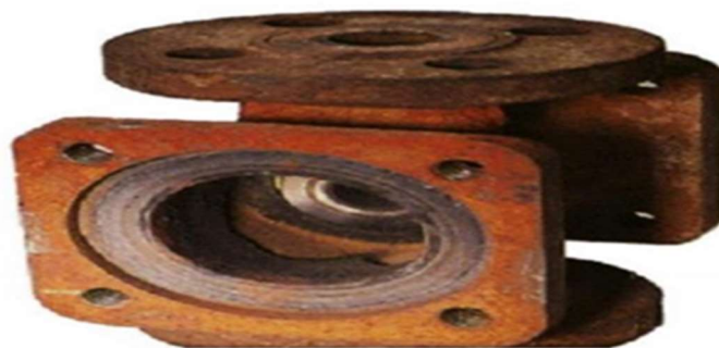
Figure I.4 Corrosion générale (rouille) d'une pièce en acier.
