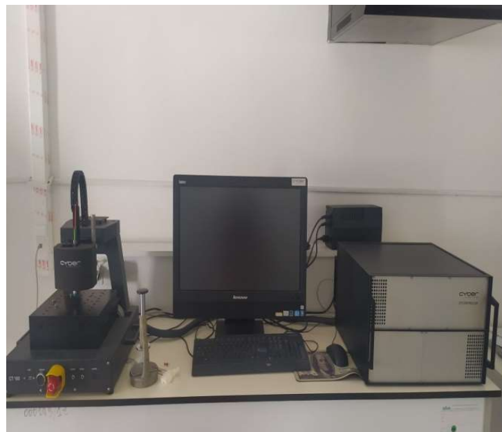
Figure III.7. Photographie de dispositif de profilomètre optique.
