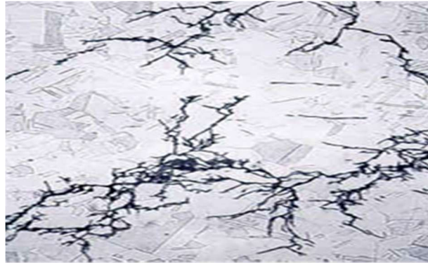
Figure I.11 Fissures transgranulaires ramifiées d'un inox.
