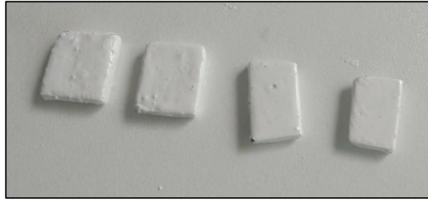
Figure III.10 : Les aciers après l'application de revêtements
