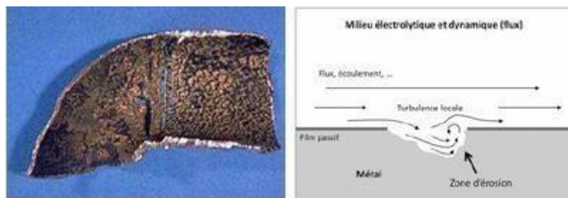
Figure I.8 : Aspect et mécanisme de la corrosion-érosion [25].
